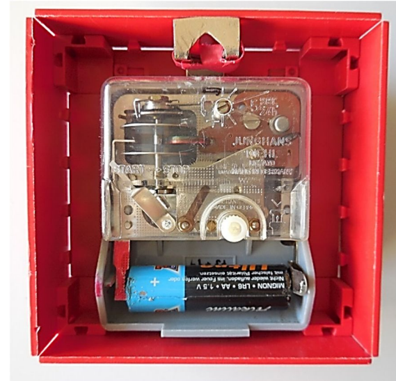
Abb. 2: Rückansicht auf Uhrwerk im fischertechnik-Gehäuse
