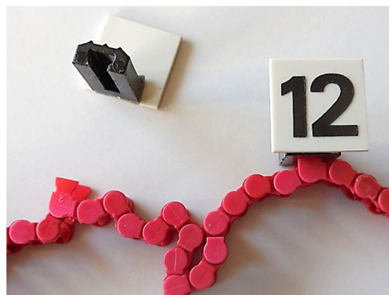
Abb. 4: Kette mit zwei Fördergliedern und zwei Zifferträgern
