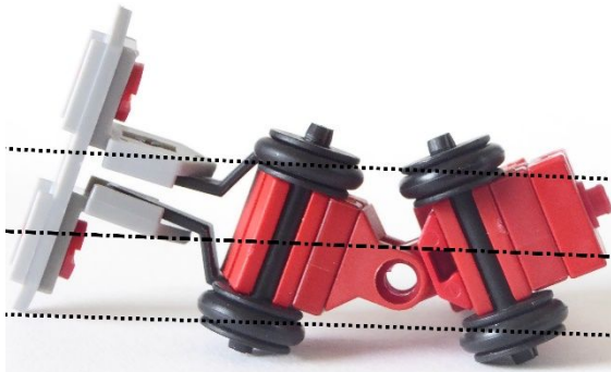
Abb. 18: Die Kipplast verringert sich mit dem Lenkeinschlag
