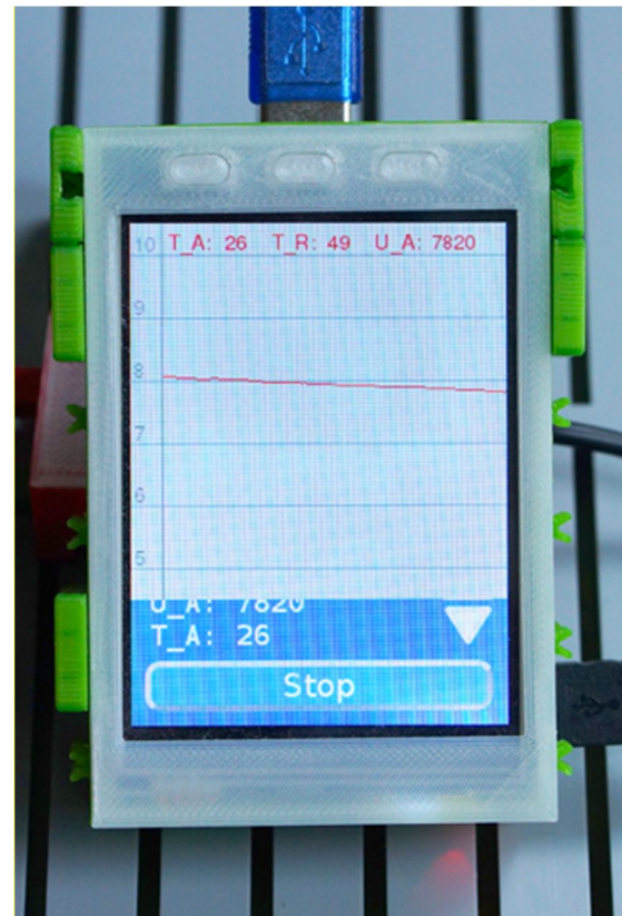
Abb. 3: Überwachung des Entladevorganges mit startIDE
