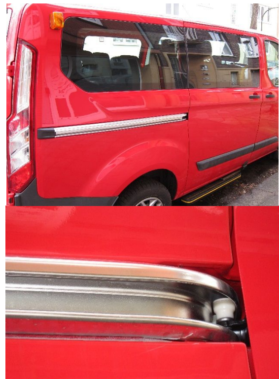
Abb. 4: Gebogene Führungsschiene einer Schiebetür
