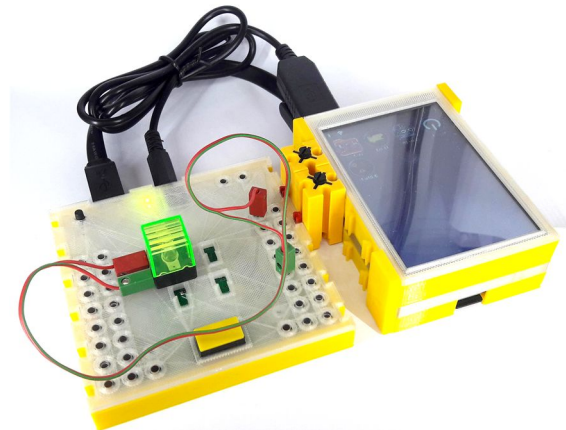
Abb. 9: Computing-Power satt: Der ftduino am Raspberry-Pi inkl. Display
