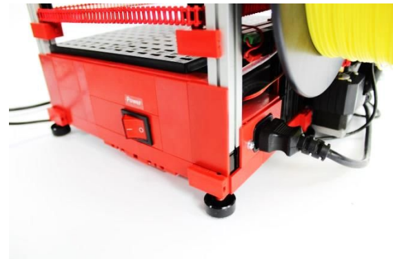
Abb. 9: Wippschalter und Kaltgerätebuchse
