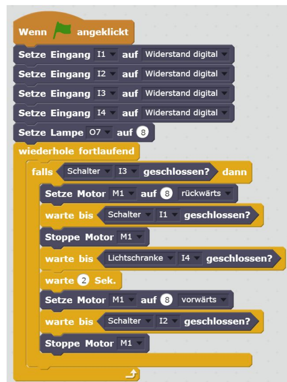
Abb. 18: Steuerung der Schranke mit FTScratch
