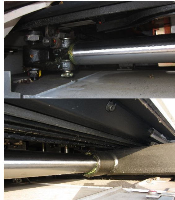
Abb. 15: Komponenten der Tür eines ICE-Wagens der Baureihe 403 (ICE 3): Tragschiene mit dem der Hauptschließkante zugeordneten Schwenklager und dem gebogenen Teil der Kulisse (oben), Gleitlager und Tragarm des Türblatts sowie gerader Teil der Kulisse (unten)
