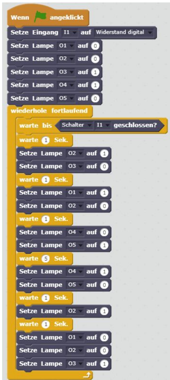
Abb. 14: Steuerung der Bedarfsampel
