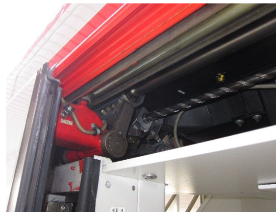
Abb. 13: Oberer Teil einer Schwenkschiebetür eines Doppelstockwagens von Bombardier
