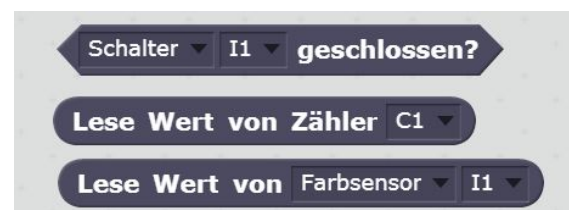
Abb. 6: FTScratch-Operatoren für den TXT
