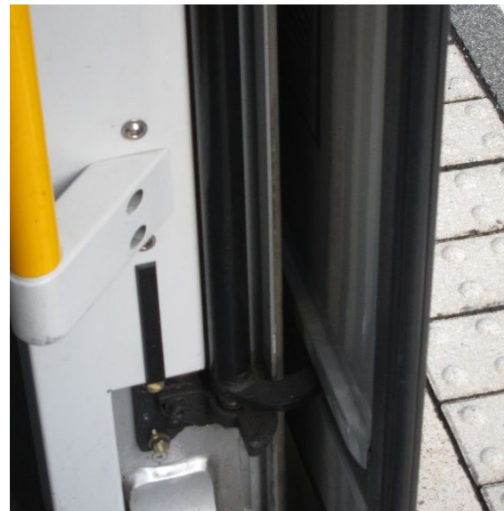
Abb. 6: Straßenbahntür: Unterer Teil der vertikalen Drehsäule mit Rollenlager sowie die zugehörige Führungsschiene im Türblatt; der obere Teil der Säule mit dem Betätigungshebel ist in Abb. 5 hinter dem Schwenkarm zu sehen.
