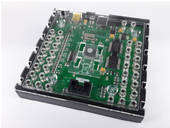
Abb. 3: Der ftDuino im transparenten Gehäuse
