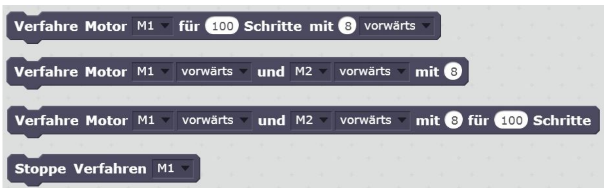
Abb. 10: Erweiterte Motorbefehle von FTScratch für den TXT
