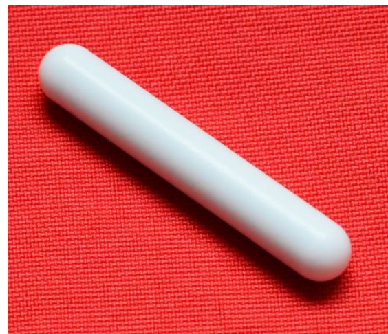
Abb. 2: Rührfisch: vollummantelter Stabmagnet
