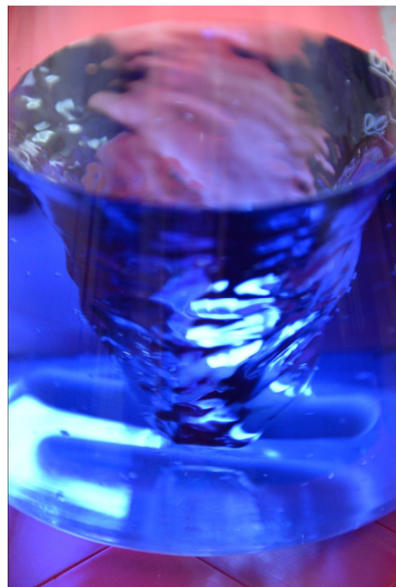
Abb. 17: Im Erlenmeyerkolben gerührte Lösung bei 75 % Drehzahl
