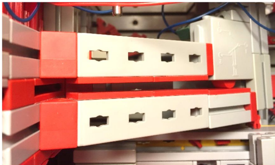
Abb. 8: Münzeinwurf und Start/Stopp-Taster (von oben)
