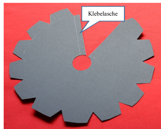
Abb. 1: Herstellung Lautsprechermembran, Schritt 1: Ausschneiden und Knickstellen einritzen
