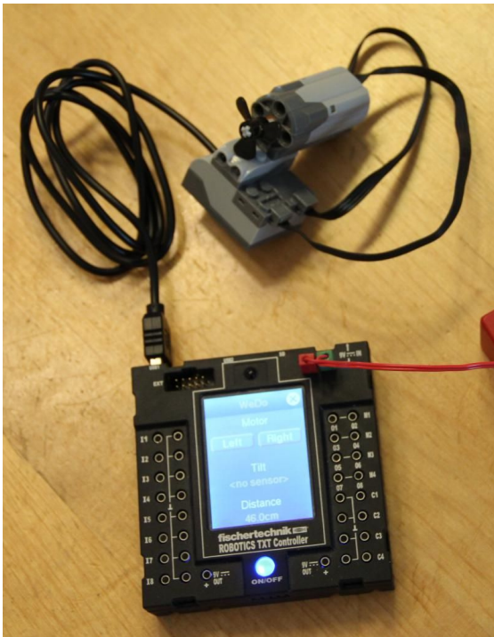
Abb. 3: Lego-Motor am TXT
