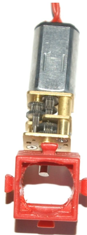
Abb. 1: Conrad „Micro Metal Gear“-Motor und ein aufgebohrter Baustein 15 mit Bohrung und zwei Federnocken
