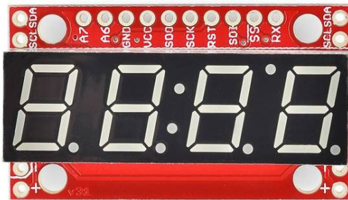
Abb. 1: Sparkfun, COM-11440 bis -3 (CC)
